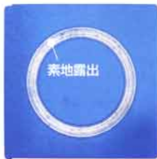
一般有機高分子塗膜 (4000回転) 素地露出
