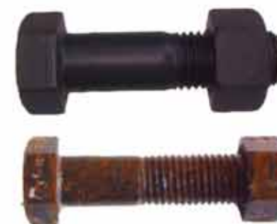
非グラフト化CNT複合塗膜 塩水噴霧時間24時間
