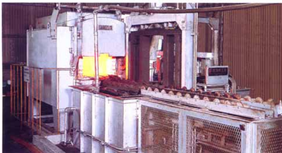
(4) 全自動溶体化処理炉 特徴 1) 最高加熱温度 1300^{\circ}\text{C} 、加熱精度 \pm 14^{\circ}\text{C} 以内 2) 出炉から水中冷却までの所要時間10秒以内
